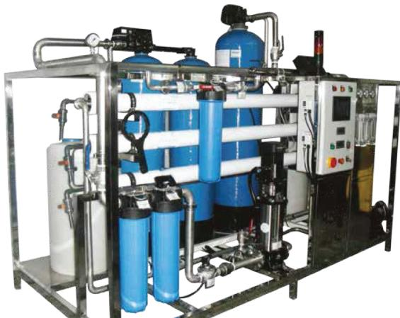
Membranların dizaynı yapılrken membranların diziliminin ve suyun yapısının çok iyi tespit edilmesi gerekmektedir. Membran dizilimi ve donanımının yapılması için teknik yeterliliğe ve uzman bir kadroya ihtiyaç duyulmaktadır. Bu nedenle kullanıcı firmalarda yanlış dizayn uygulamalarından dolayı çalışmayan yüzlerce Reverse Osmosis Sistemi bulunmaktadır.
